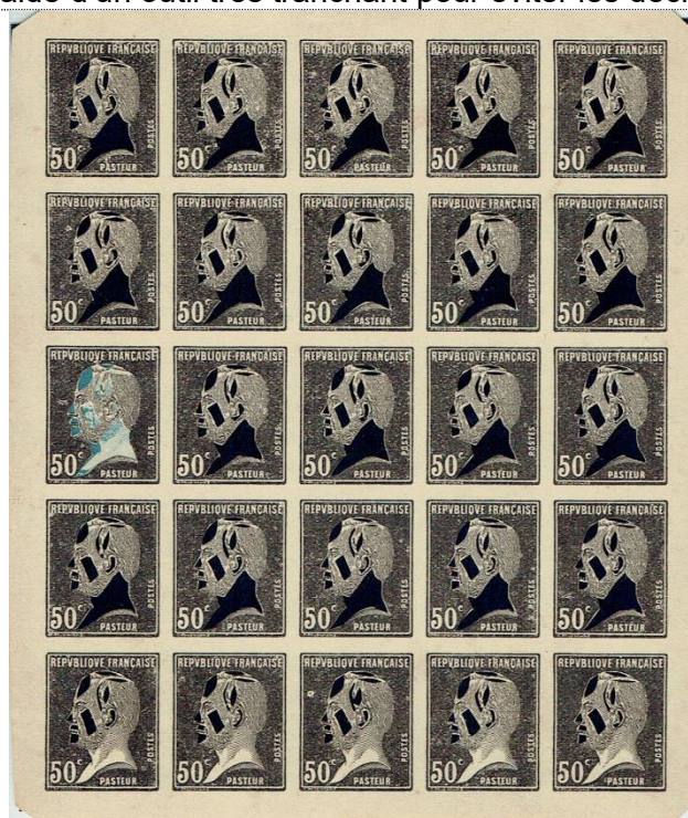
Coussinets destinés à l'impression des timbres de feuilles en typographie à plat (marges courtes).
